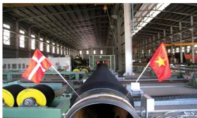
Ảnh 4. Sau các quá trình bọc chống ăn mòn và cách nhiệt, sản phẩm được bọc bê tông gia trọng
